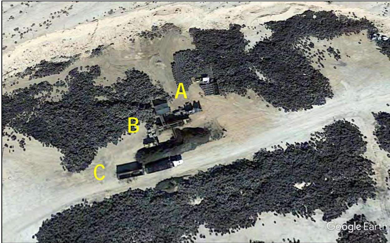
**Imagen 8. Imagen satelital de CATENED I (Mexicali). Nótese el equipo de trituración (A) y el cargador frontal (B) que carga un remolque (C) con llantas trituradas para su transporte al horno cementero de Hermosillo. Noviembre 2016. Fuente: GoogleEarth.**
